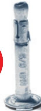
Der MND Nageldübel spreizt vor, deshalb ist kein Halten des Werkstücks notwendig. Das spart bis zu 15 % Arbeitszeit bei der Montage.
